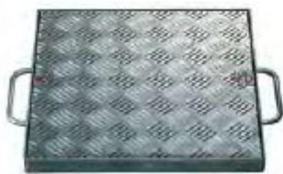
Tampon en aluminium à couvercle. Hauteur 50 mm, passage libre 500 x 500 mm, dimensions extérieures 560 x 560 mm. Résistant à une charge répartie de 10 kN au m2. Composé d'un cadre à sceller avec étriers d'ancrage en forme de poignées et joint d'étanchéité et d'un couvercle en tôle pleine larmée antidérapante. Dispositif de condamnation et d'extraction en laiton avec deux clés de manutention.
