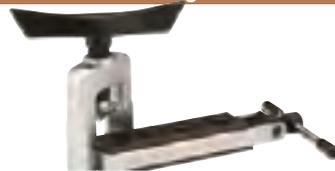
Dudgeonnière - Evaseur conique excentrique - système débrayable protégeant le tube à évaser d'un serrage excessif. pour tubes 3/16" - 1/4" - 5/16" - 3/8" - 1/2" - 5/8" - 3/4" OD
