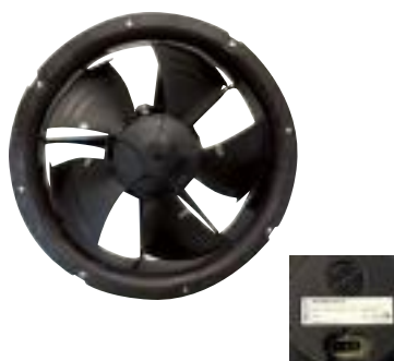
W1G200-EC87-25 230V - 8,5W - 1300 tr/min 0,07A - 460m3/h - IP54 Fixation par câble
